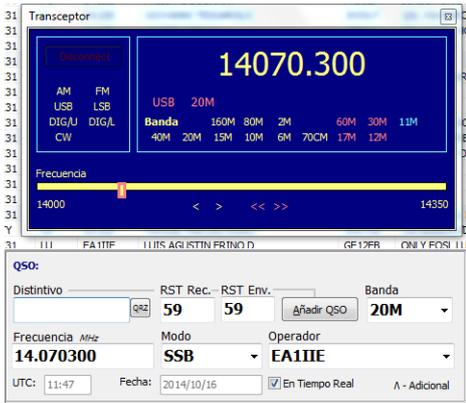
Podremos automatizar nuestros contactos, ya sean en modos digitales o no, mediante el control CAT. Usando la opción de configuración anterior, podremos abrir la ventana de control del Transceptor:
